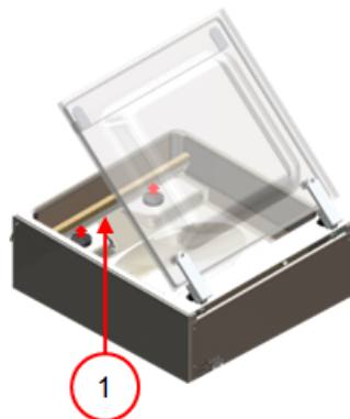
Figura 5: Extracción de la barra de sellado
