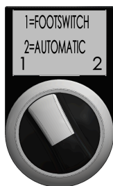
Schéma 20 : Commutateur du couvercle automatique
