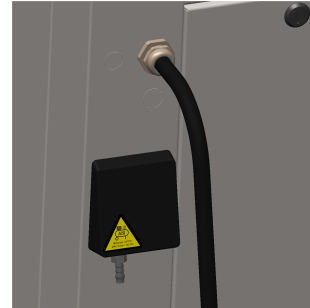
Abbildung 8: Schlauchanschluss für Druckluft
